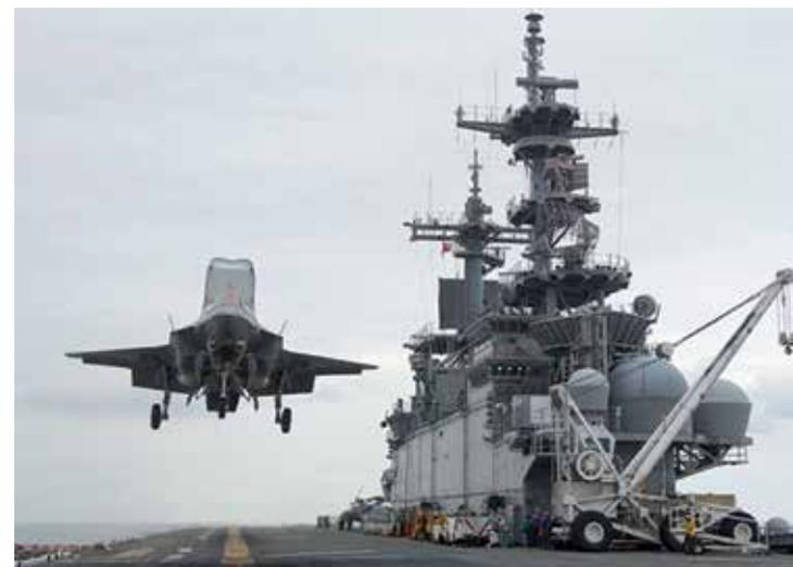
Foto 3. Test di atterraggio verticale di un F-35B sulla nave USS WASP.
