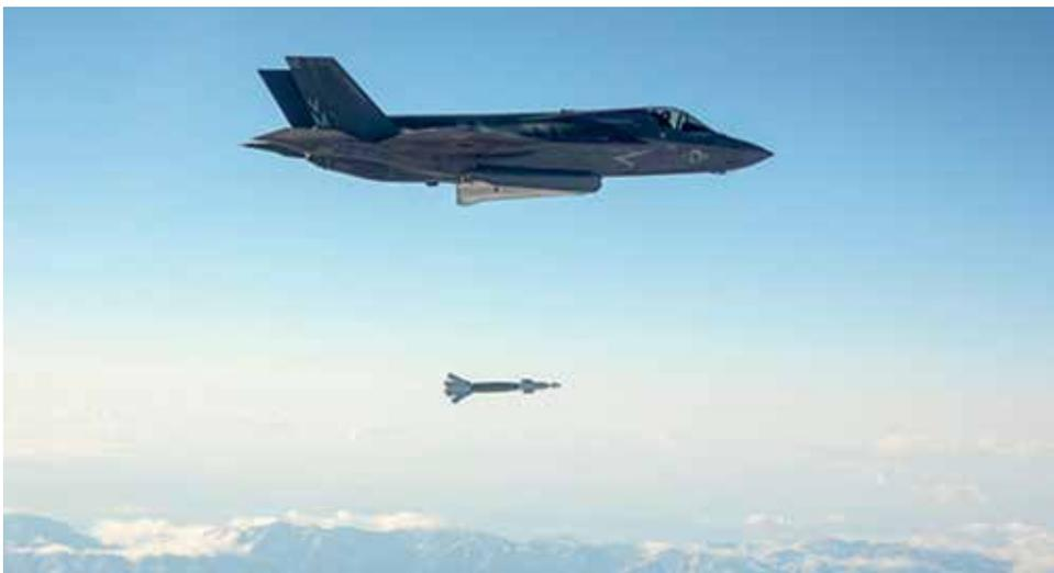
Foto 2. Test d'impiego di una bomba a guida laser Paveway II (GBU-12) da parte di un F-35.
